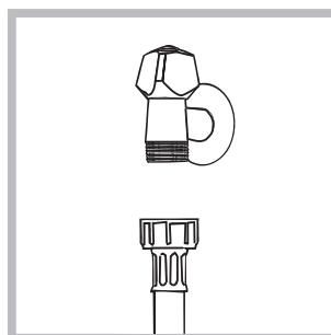
1. Conectar el tubo de tubo enroscándolo a un grifo de agua fría con la boca rosizada de 3/4 gas (*ver la figura*). Antes de conectarlo, haga correr el agua hasta que esté limpida.
